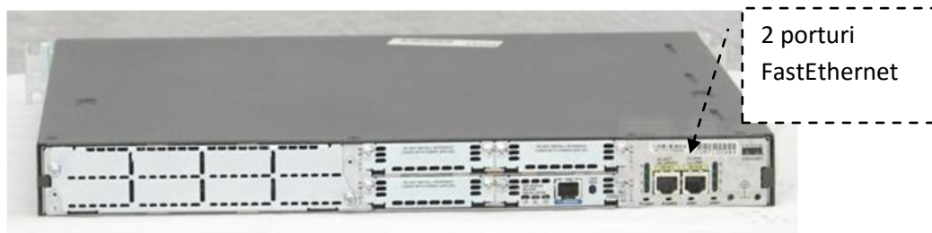
Figura 1 Router Cisco 2800 un număr redus de porturi de rețea și un număr limitat fizic de module în care se pot instala porturi adiționale
