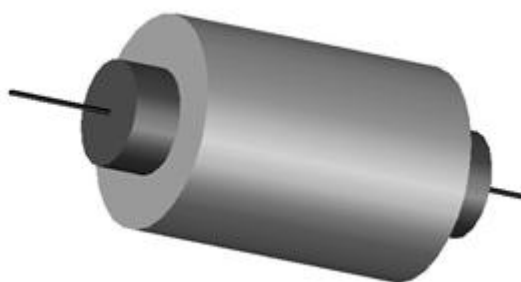
Fig. 2.3 Primele trei straturi ale unei fibre optice monomod, reprezentate în AutoCAD: a) miezul de grosime 8\mu\text{m} ; b) cămașa de grosime 125\mu\text{m} ; c) bufferul de grosime 250\mu\text{m} .
