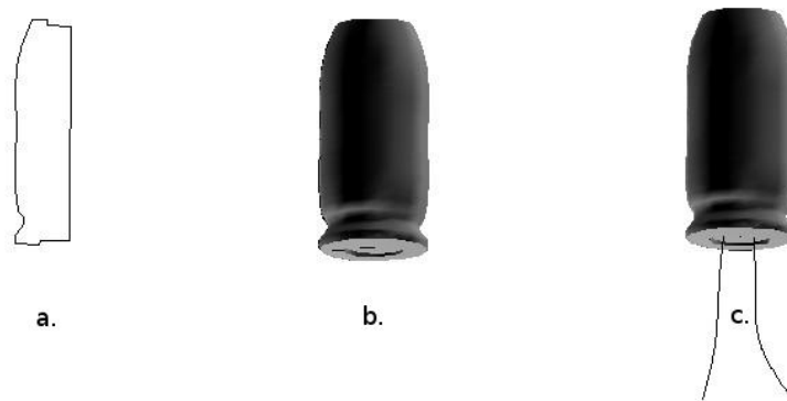
Fig. 3.2 Etapele necesare desenării unui condensator electrolitic: a) schițarea siluetei; b) rotația siluetei în jurul axei de simetrie; c) desenarea firelor.
