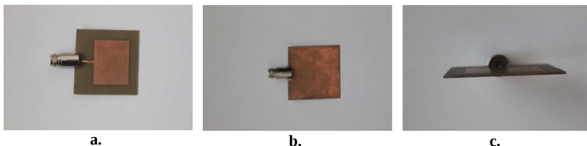
Figura 3. Exemplu de antenă patch line-fed rectangulară realizată în laboratorul de microunde al Universității din Pitești: a. vedere de sus (fața cu patch-ul), b. vedere de dedesubt (fața cu masa); c. vedere laterală (muchie).
